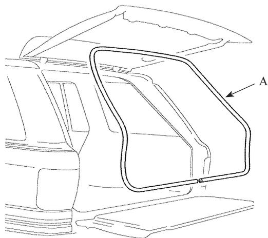
A BHK720020 Dichtung Heckklappe
